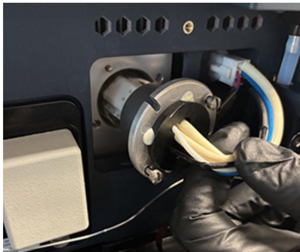
9. Posicione a nova lâmpada de modo que o recorte localizado na base da lâmpada esteja na posição de 11 horas, alinhado com o pino de alinhamento no alojamento da lâmpada.
