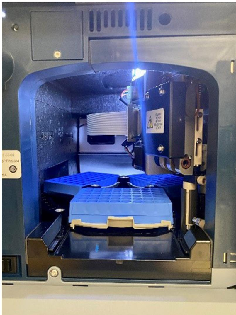
Figura 6–4: Posições das ampolas na placa de amostras
