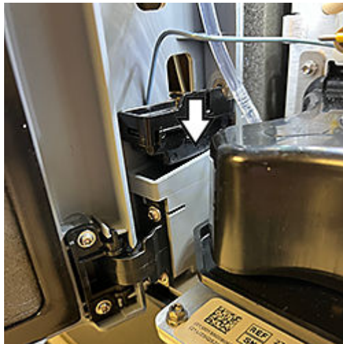
図 4-18: ドレインカップの取り付け
