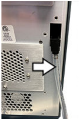
図 4-22: 結露廃液ラインを取り外す
