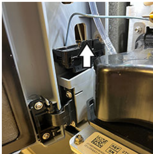
図 4-12: ドレインカップを上を持ち上げる
