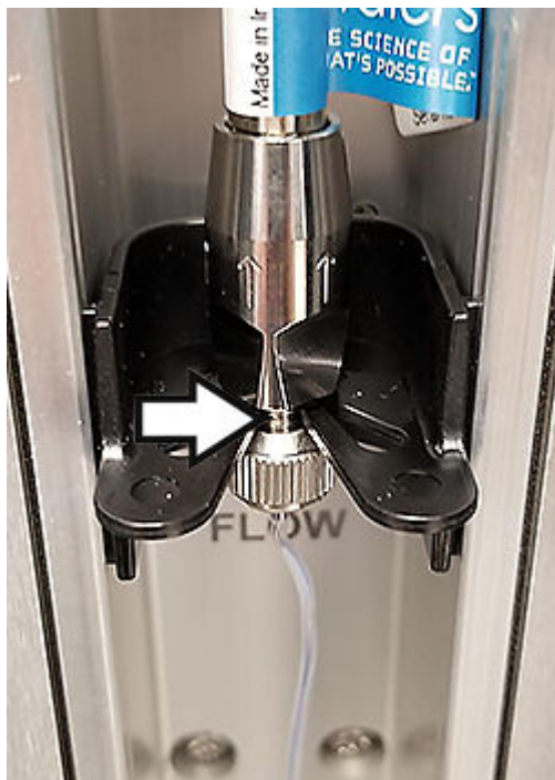
図 4-4: カラムクリップに固定されているカラム
