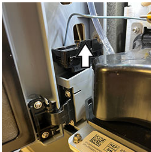
Figura 4–12: Sollevamento della coppa di drenaggio
