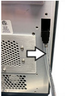
Figura 4-22: Scollegamento della linea di scarico della condensa
