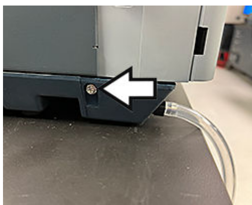
Figura 4–19: Vite del vassoio di drenaggio
