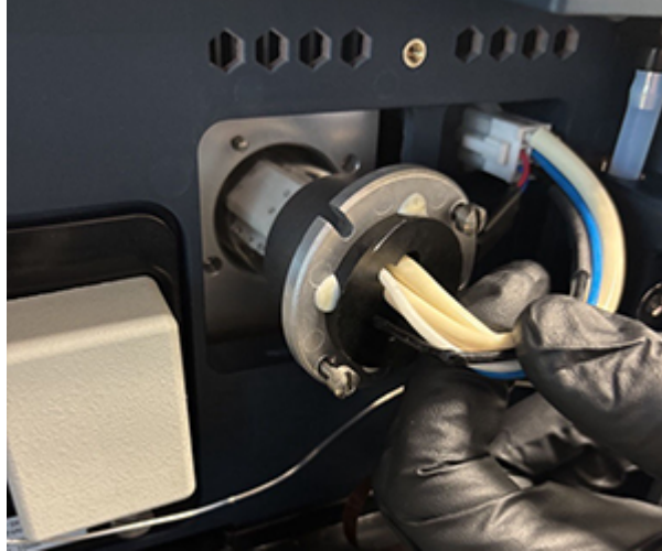
Figura 8–65: Rimozione del gruppo della lampada
