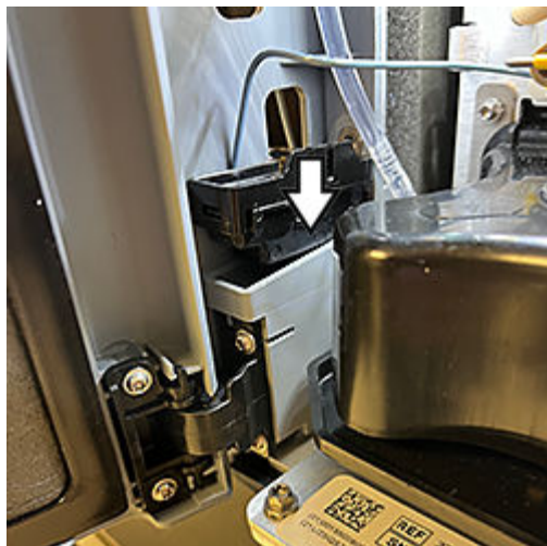
Figure 4–18 : Installation de la poche de vidange
