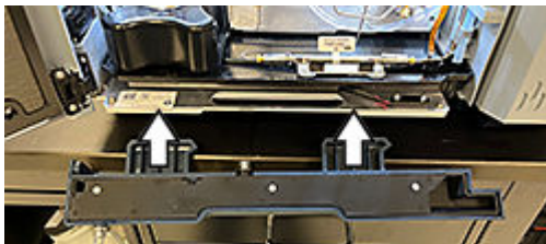
Figure 4–17 : Installation du bac d'évacuation
