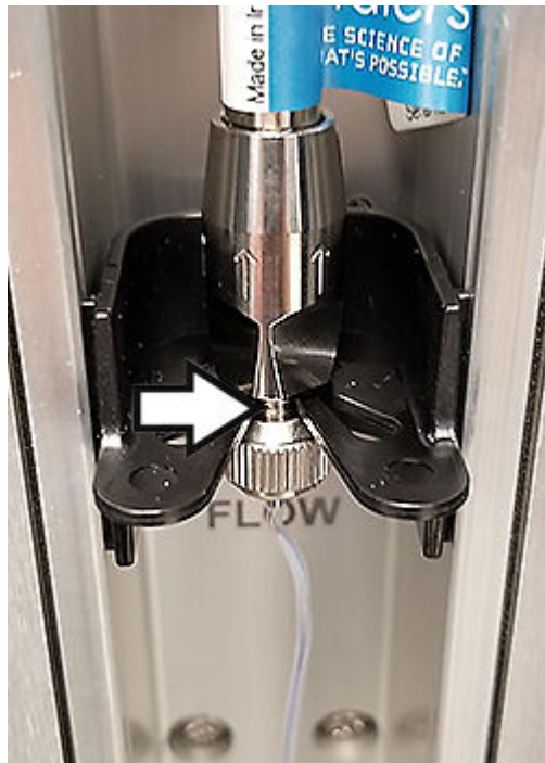
Figure 4-4 : Colonne installée dans l'attache de la colonne
