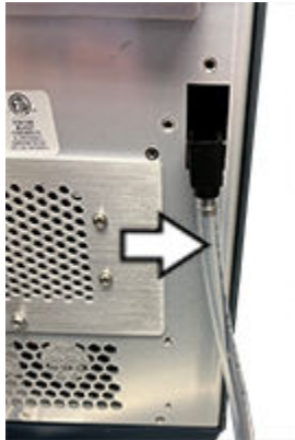
Figure 4–22 : Débranchement de la ligne d'évacuation des déchets de condensation
