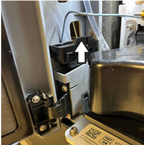
Abbildung 4–12: Anheben des Ablaufbehälters
